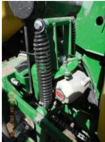
2-es ábra, A hidraulikus munkahenger, emelő rugók és hidroakkumulátor
