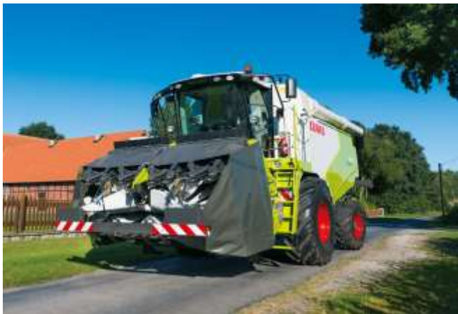
A CorioConspeed adapter szállítási helyzetben
